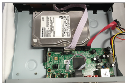
ハードディスクを図のように置きます。向かって右側が接続端子部分です。
