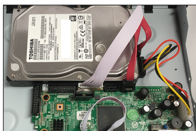
ハードディスクを図のように置きます。向かって右側が接続端子部分です。
