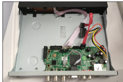
カバーを外し、ケーブルを解きます。
