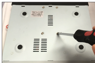
本体裏面からねじで固定します。固定するまでは手で押さえてねじを回してください。
