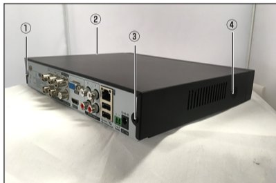
DVR(録画機)の4点のねじをプラスドライバーで外します。
