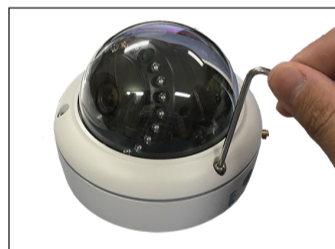
星型レンチでドームカバーの 3 点のねじを緩め、カバーを外します。
