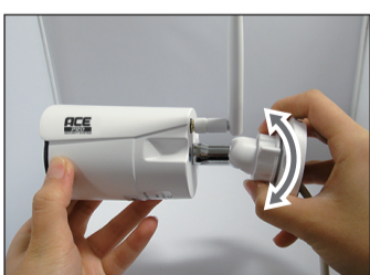
カメラブラケットのダイヤルを回して緩め、ブラケットを調整しやすい角度に曲げます。
