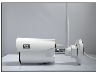
アンテナを上 (天面) に向けて立てます。
