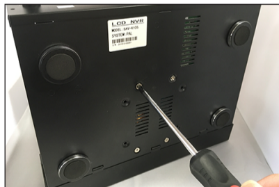
ハードディスクを本体裏面からねじで取り付けます。
