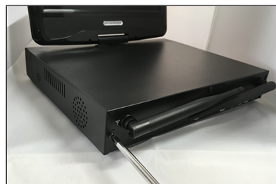
5点のねじを締めて完了です。
