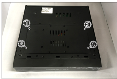
本体裏面ハードディスク取付蓋の4点のねじを外します。
